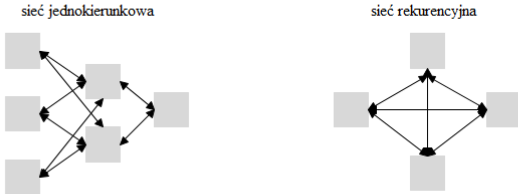
Rys. 3.5. Przykładowe sieci jednokierunkowa i rekurencyjna typu Hopfielda
